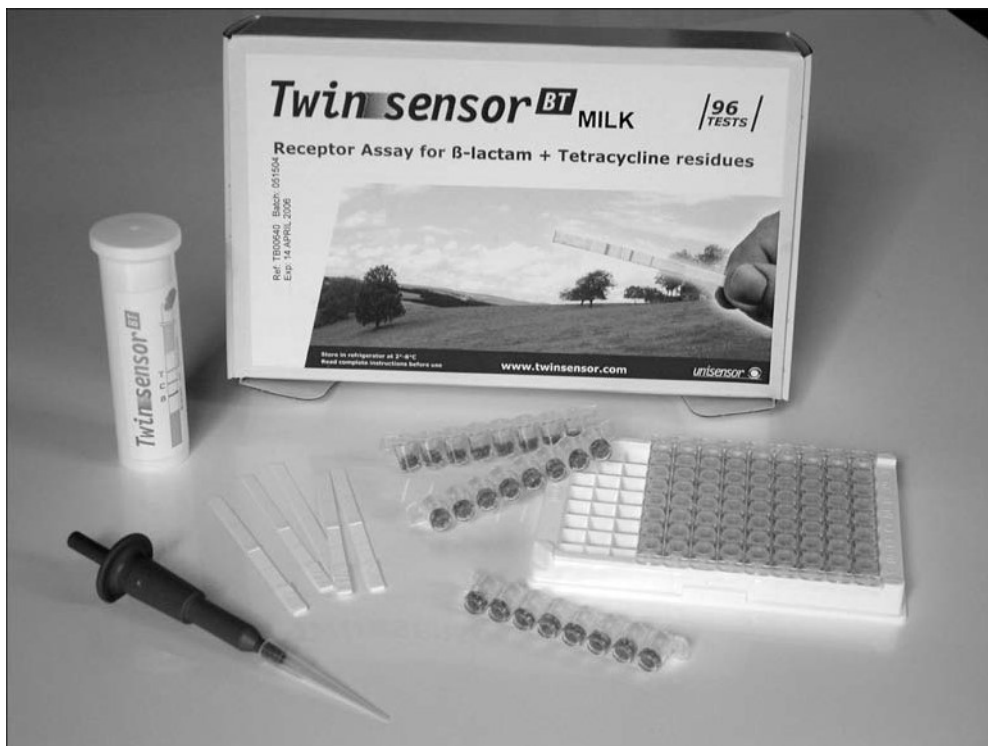
Slika 4. IZGLLED I SADRŽAJ TWINSSENSOR KITA (ZA 96 ANALIZA) Figure 4. TWINSSENSOR TEST KIT (FOR 96 ANALYSES)
