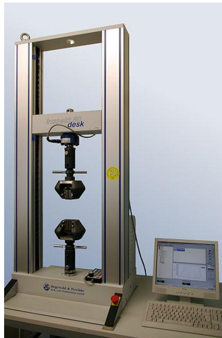
Slika 2.9. Određivanje zatezne čvrstoće uzoraka na kidalici
