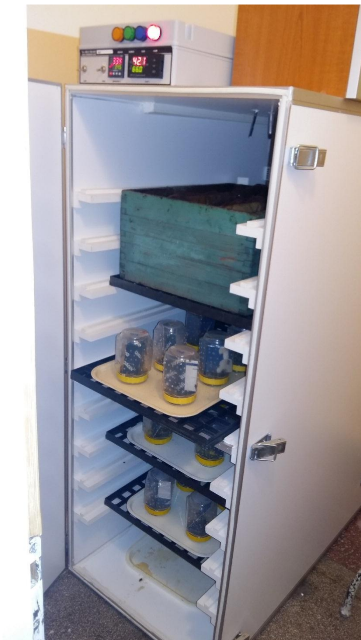
Слика 4: Инкубатор који константно одржава задате вредности температуре и влаге, са убаченим леглом (рамови у корпусу кошнице) и пчелама у експерименталним кавезима.
