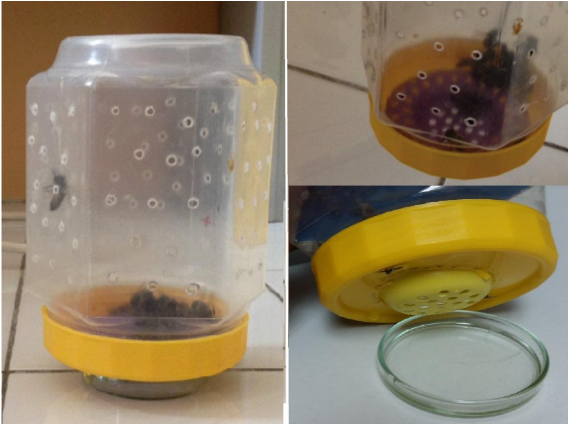
Слика 5: Модификација лабораторијског кавеза: Пластична тегла са малим рупама направљеним за вентилацију и пластичном решетком за судоперу, која је фиксирана у поклопац омогућавајући пчелима да узму храну из мале петријеве шоље постављене испод.
