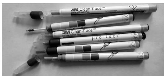
Slika 7. Brisevi za dokazivanje organskih ostataka na površinama u industriji hrane (Autorska fotografija)
