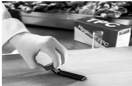
Slika 5. Uzimanje uzorka sa površine pomoću Hygicult-a
