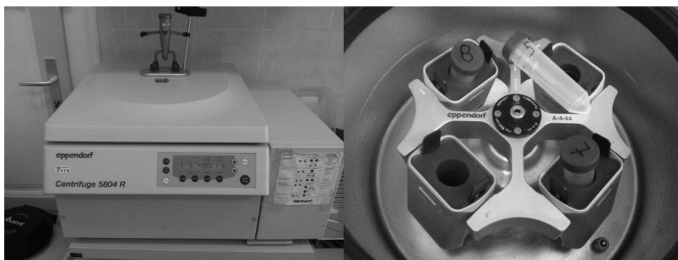
Slika 1. Centrifuga sa hlađenjem ili grejanjem Naučni institut za veterinarstvo „Novi Sad“, Odeljenje za reprodukciju
