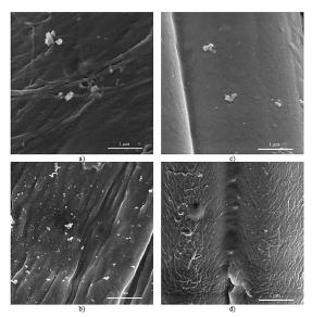
Figure 3: FESEM images of (a) CO+BTCA4+Cu, (b) CO+BTCA6+Cu, (c) CV+BTCA4+Cu and (d) CV+BTCA6+Cu fibers
