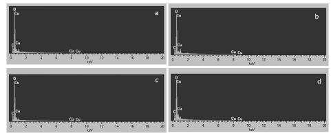
Figure 4: EDS spectra of (a) CO+BTCA4+Cu, (b) CO+BTCA6+Cu, (c) CV+BTCA4+Cu and (d) CV+BTCA6+Cu fibers
